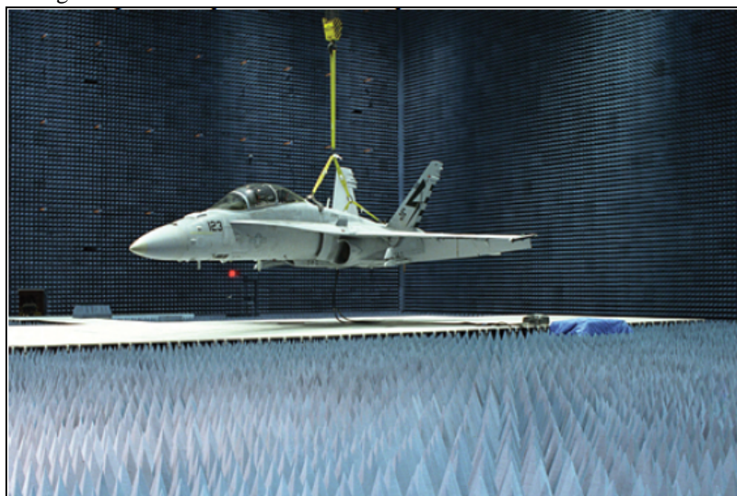
Figura 5- aeronave F-18 em ensaio de RCS dentro de câmara anecóica
